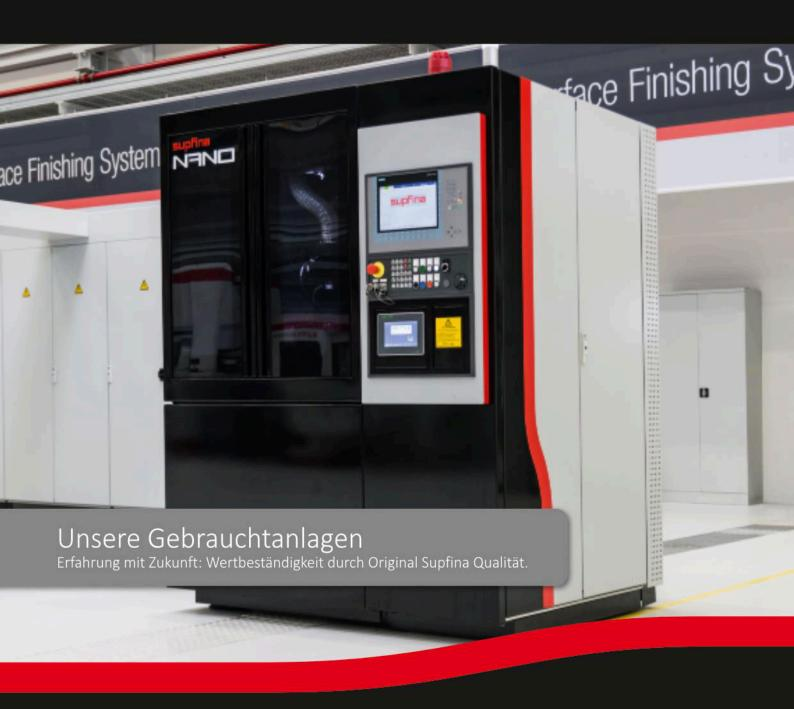
Kompakte Superfinish-Maschine für die Planbearbeitung
