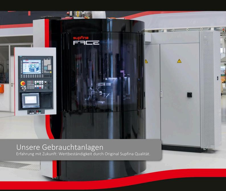
Rundtakt-Maschine für die Planfinish-Bearbeitung
