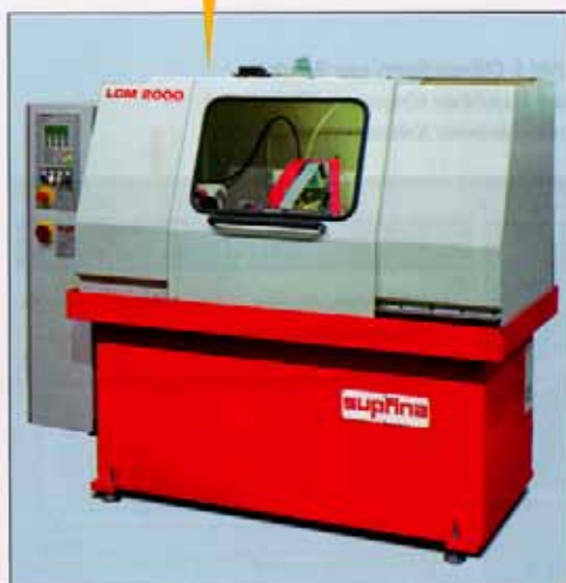
Bild 3: Lean-Cost-Maschine für die Dryfinish®-Bearbeitung kleiner Serien.
