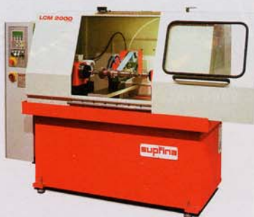
2 Superfinishmaschine ›LCM2000plus‹ zum Bandfinishen einer Lagerstelle
