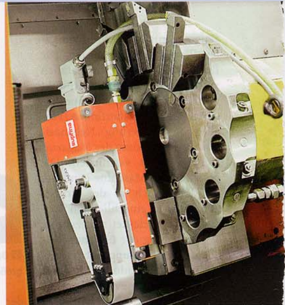
1 Bandfinishgerät ›Supfina 210‹ in einer Schrägbett-Drehmaschine
