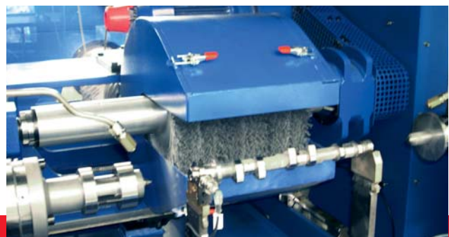
Bürststation zum Entgraten von Nockenwellen
