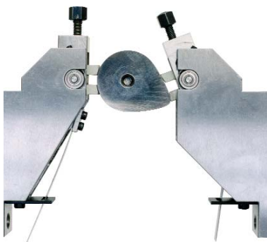
Usinage par pierre des cames avec porte-pierre oscillants spéciaux servant à éviter la déformation de la géométrie
