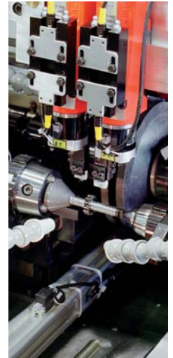
Exemple d'usinage d'un pignon de pompe. Usinage des portées et des faces.
