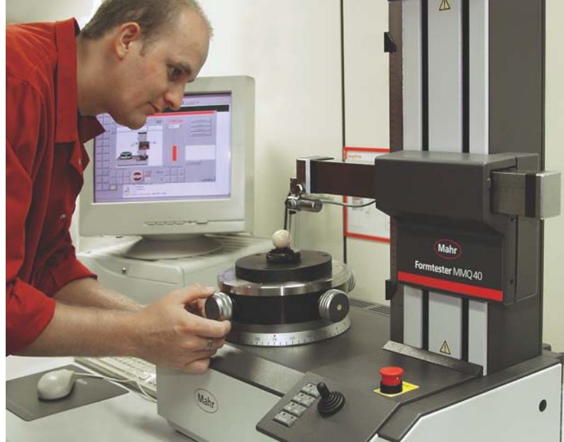
Messraum, keramische Kugel auf MMQ40
