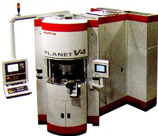
2 Kranhakenmaschine für das Doppelseiten-Planschleifen: Die ›Planet V4‹ hat die Stückkosten im Visier
