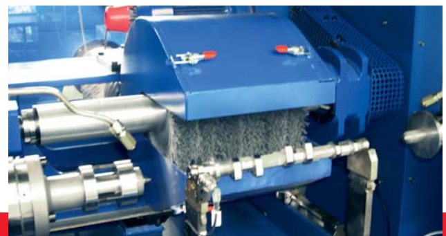
Station de brossage pour l'ébavurage des arbres à cames
