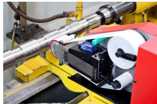
Abb. 4+ 5 Supfina 210 Superfinish-Anbaugerät auf einer Drehmaschine
