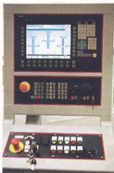
Die Planet V4 arbeitet mit der Sinumerik 840D als CNC-Steuerung: Die Bedienoberfläche der Steuerung wurde speziell auf das Doppelseiten-Planschleifen hin gestaltet. Das Bild zeigt die genaue Anzeige des Schleifspaltes.
