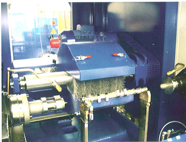
Bild 2: Die Bearbeitung von Nockenwellen stellt ganz andere Anforderungen an das Maschinenkonzept. Hier müssen Lagerstellen und Steuernocken gefinisht werden. Abschließend erfolgt dann noch eine Kantenverrundung an den Steuernocken
