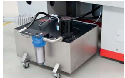
Verfahrbarer Filterwagen: platzsparend im Maschinenständer integrierbar
